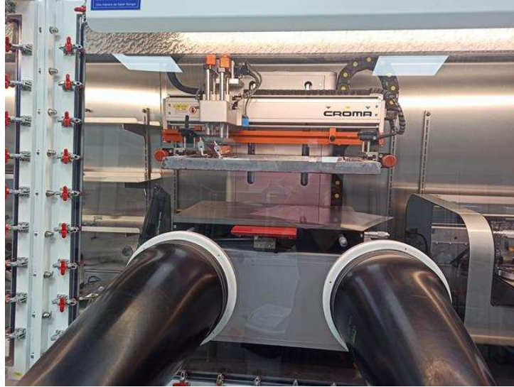
Figura 16. Imagen de la máquina de serigrafía integrada en la caja de guantes
