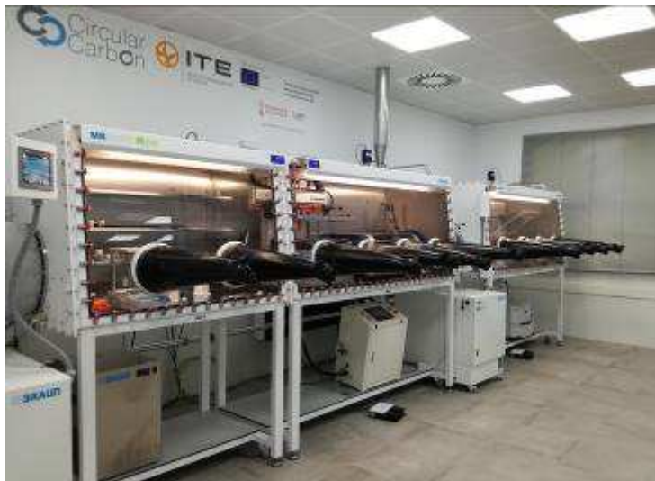
Figura 14. Fotografía de la caja de guantes instalada.
