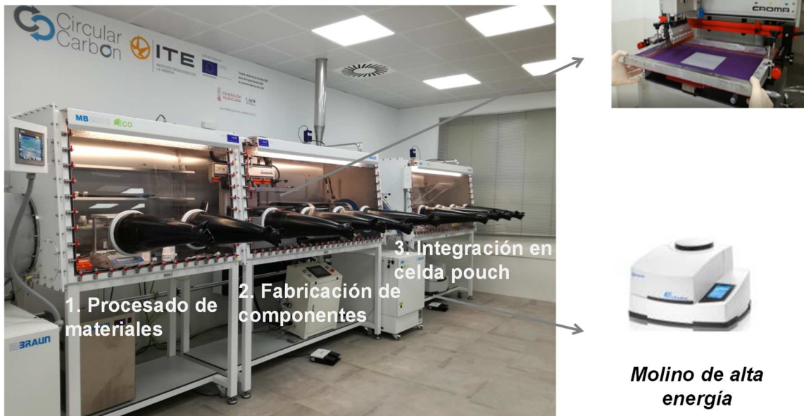
Figura 17. Imagen de la línea fabricación e integración de componentes de celdas de baterías CIRCULARCARBON instalada en ITE
